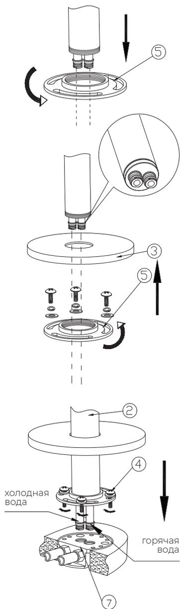
5. Отвинтите фиксирующее кольцо (5), оденьте декоративную крышку (3) на корпус (2), вставьте фиксирующее кольцо (5) обратно и закрепите.
