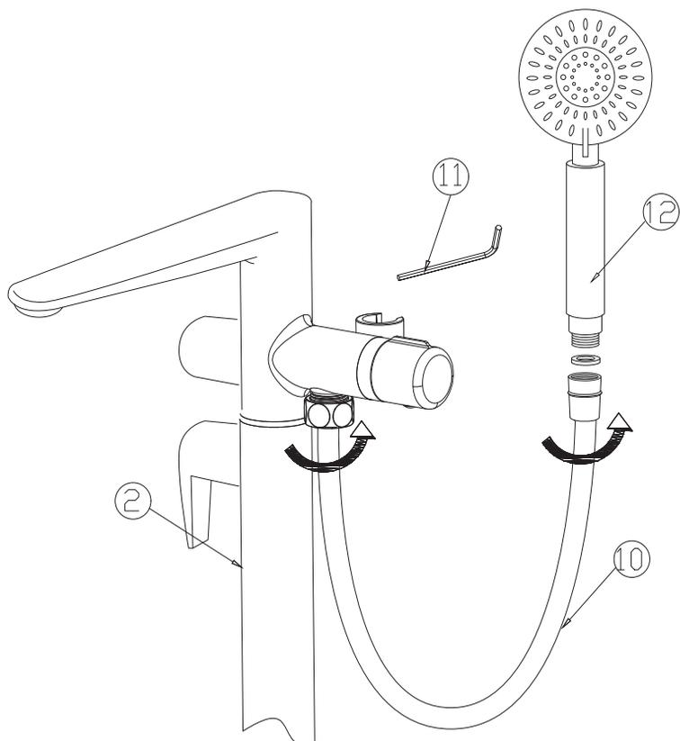
7. Шланг (10) соедините с корпусом смесителя (2) и ручным душем (12).
