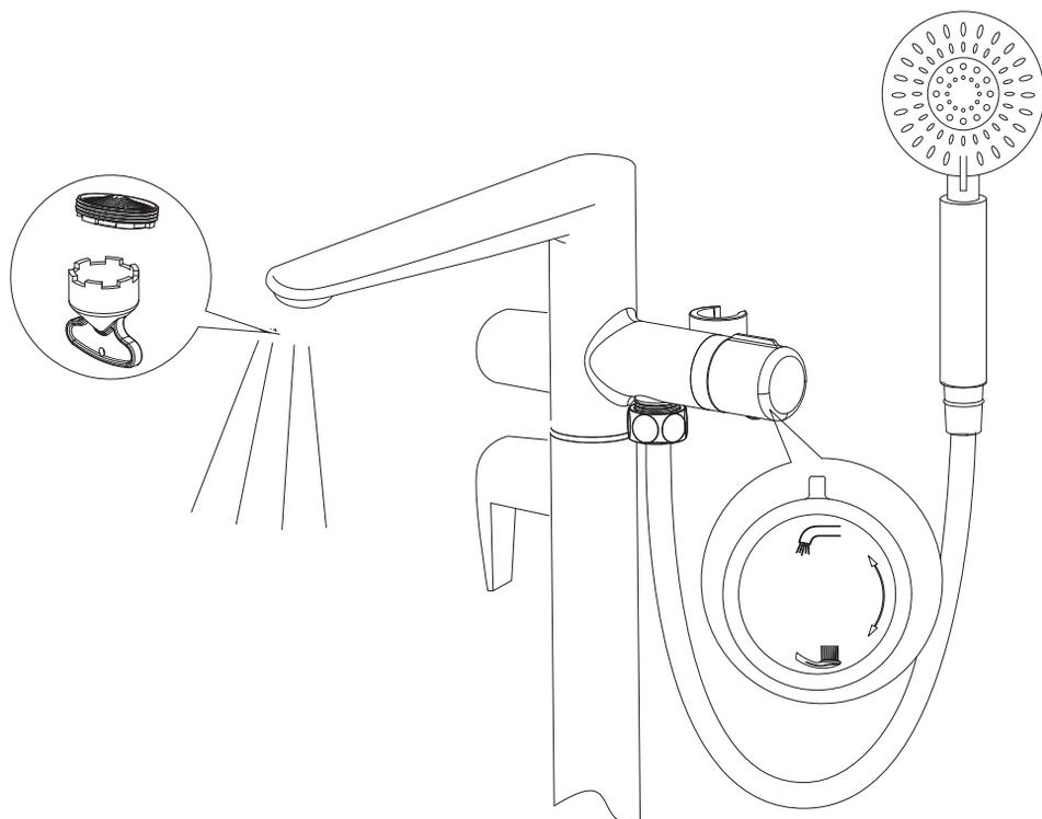
9. Выкрутите аэратор и включите подачу воды в смеситель, убедитесь, что в собранной конструкции нет протечек.
