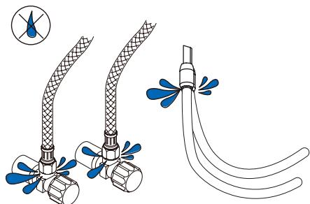
Проверьте все соединения на герметичность.
