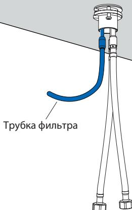
Соедините трубку подачи питьевой воды с трубкой водяного фильтра.
