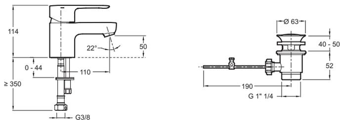
Спецификация продукта: Однорычажный смеситель для раковины. E16027-4. Коллекция: JULY. Вес: 1,3 кг. Тип установки: 1 отверстие. Расход воды: 10 л/мин при давлении 3 бар. Механизм: Картридж с регулируемым ограничителем температуры и чувствительным ограничителем расхода воды.
