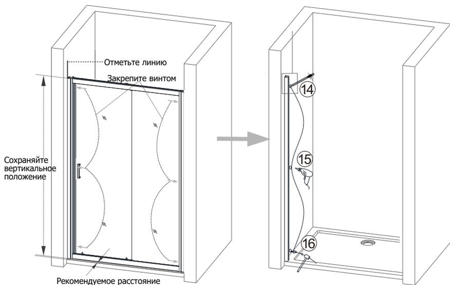
I-1) Вставьте, пожалуйста, алюминиевую раму в душевой угол с одной и с другой стороны, затем установите ее в нужное место и сделайте карандашом отметку где необходимо высверлить отверстия для фиксации. Затем выньте алюминиевую раму, просверлите отверстия в стене, вставьте в них дюбеля и зафиксируйте раму к стене винтами (ST4x25).
