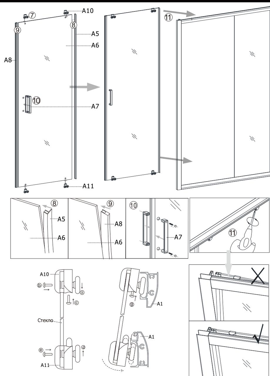
3.1) Закрепите ролики на раздвижной стеклянной двери, отрегулируйте дверь. Установите водонепроницаемые уплотнители и магнитные уплотнители.
