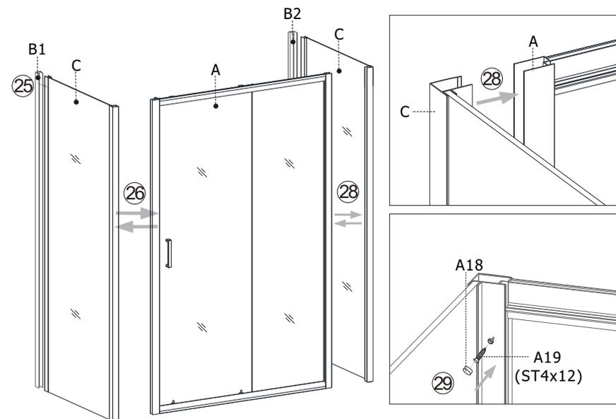
6.1) После установки в исходное положение зафиксируйте душевой угол. Фиксация U-образного душевого угла осуществляется по принципу фиксации L-образного душевого угла. Установка L-образного душевого угла основывается на руководстве по установке I-образной ее формы, а установка U-образного душевого угла основывается на руководстве по установке L-образной ее формы.
