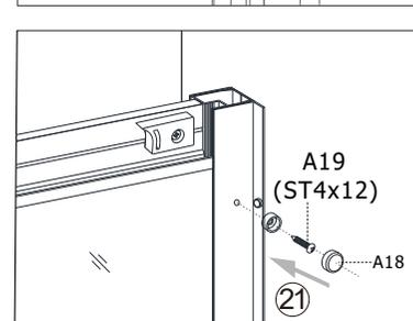
1-2) В завершении, установите душевой угол в отмеченное место, затяните винты и соедините внешний и внутренний профиль, после чего наденьте на винт декоративный колпачок.
