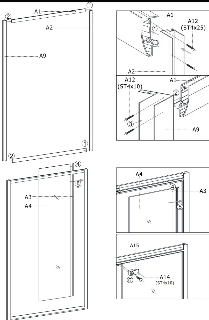
2.1) Закрепите алюминиевую раму в верхней и нижней пазы с помощью винта A12 (ST4x25). Наденьте U-образный уплотнитель на неподвижное стекло и вставьте его в алюминиевый профиль. Затем закрепите стекло с помощью L-образной детали (A15).
