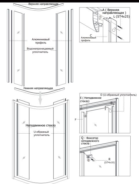
2.1) Скрепите алюминиевый профиль и верхнюю направляющую винтом K(ST4\*25). Установите U-образный уплотнитель на неподвижное стекло и вставьте в алюминиевый профиль, закрепите на неподвижном стекле фиксатором неподвижного стекла и винтом R (ST4\*10)
