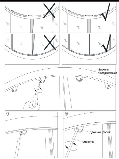
5.1) Пожалуйста, установите ролики раздвижной двери в алюминиевую направляющую. Если середина 2-х раздвижных дверей находится не по вертикали или, если после установки магнитного уплотнителя между 2-я дверьми имеется зазор, следует отрегулировать винт на роликах с помощью отвертки, чтобы 2-е раздвижные двери плотно прилегали друг к другу
