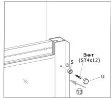
3.2) Наконец, соедините профиль регулировки и алюминиевую раму с винтом (ST4x12) и пластиковую прокладку (s), а затем закрепите декоративный колпачок на винт.
