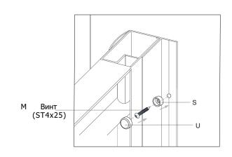
3.1) Пожалуйста, вставьте регулировочный профиль установив его в нужное место, сделайте отметку карандашом, затем отложите профиль в сторону, сделайте отверстия в стене, вставьте пластиковый дюбель и прикрепите его к стене винтом (ST4x25).
