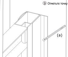
Отметьте 6 отверстий; Переместите душевой угол и просверлите отверстия, затем установите пластиковый дюбель.
