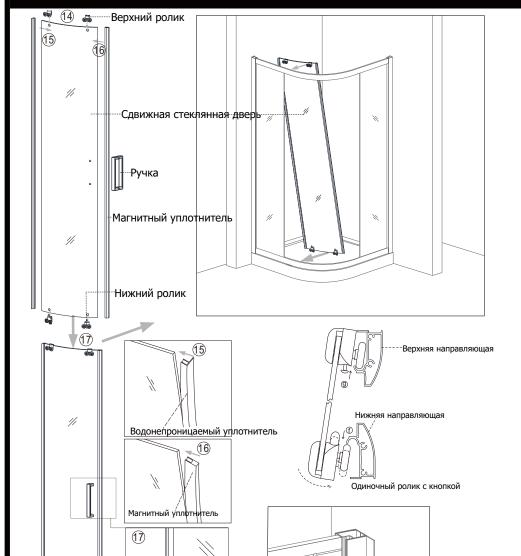
4.1)З акрепите ролики на раздвижной стеклянной двери, отрегулируйте дверь и наденьте на ролики крышку. Установите водонепроницаемый уплотнитель и магнитный уплотнитель. 4.2)Установите раздвижную дверь на направляющий профиль. Отрегулируйте винт на колесе для плавного хода двери
