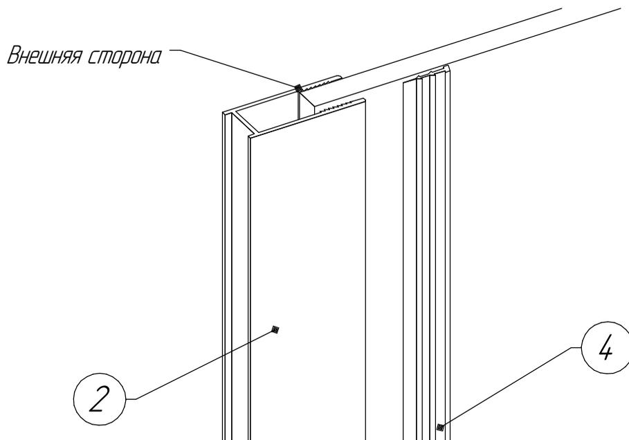
3. Соедините данную перегородку через соединительный профиль (3) при помощи винтов (6). Для винтов (6) необходимо сделать отверстия в обоих профилях диаметром 3 мм.
