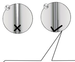
Отрегулируйте раздвижные двери с помощью винтов, расположенных в нижней части верхних роликов в сборе. Отрегулируйте ролики так, чтобы раздвижные двери были параллельны к неподвижным панелям и параллельно друг другу. Примечание. Не перетягивайте верхние ролики, так как это может привести к заклиниванию или поломке нижних роликов.
