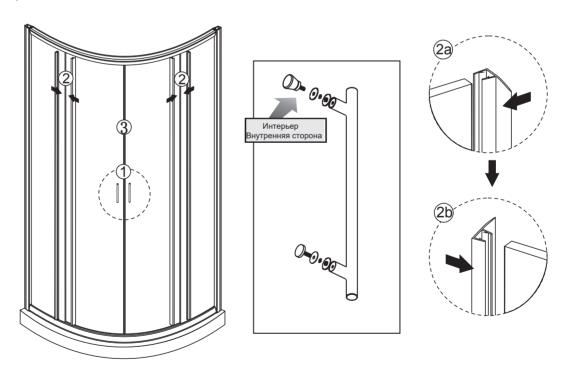
Отрегулируйте корпус, чтобы он был ровным. Ролики должны быть отрегулированы так, чтобы двери были ровными и обеспечивали плавный ход
