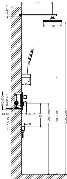
Определите точное место установки смесителя.
