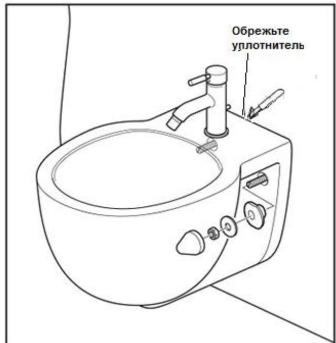
**16.** С каждой стороны биде наденьте пластиковые и металлические шайбы на болты, закрепите гайками и вставьте крышки.
