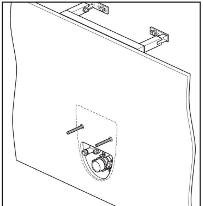
**12.** Постройте перегородку, проделав отверстия для болтов и труб. При необходимости выложите плитку на поверхность перегородки или нанесите отделку.
