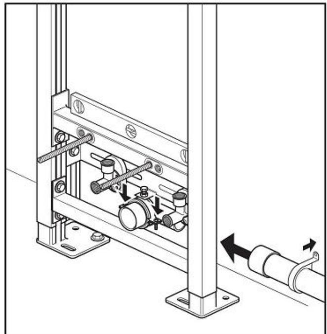
**7.** Осторожно поднимите и навесьте биде на крепежные болты. Ослабьте опорные болты крепления биде и установите планку на требуемую высоту. Ослабьте болты регулировки высоты соединения, установите опорную планку соединения на требуемую высоту на уровне выпускного колена для слива отходов. Снова затяните болты.
