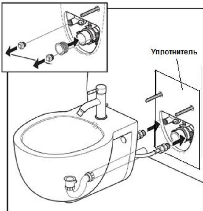
**15.** Снимите заглушки с патрубков. Вставьте уплотнение сливной трубы в выпускное колено и смажьте изнутри.
